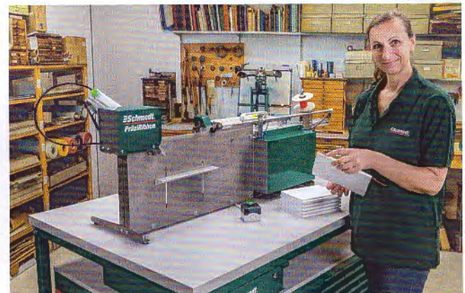
„PräziRibbon“ – Gerät zum Ankleben und Einlegen von Kapitalband.
