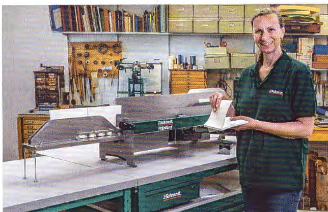
„PräziGard“ – Gerät zum Ankleben von Vorsatzpapier an fertige Buchblöcke.
