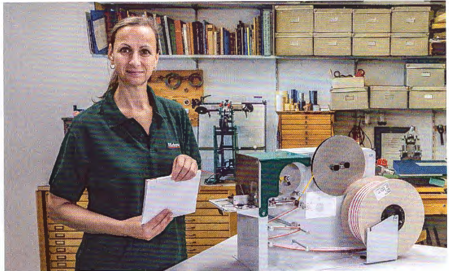
„PräziBand“ – Gerät zum Ankleben von Kapitalband.
