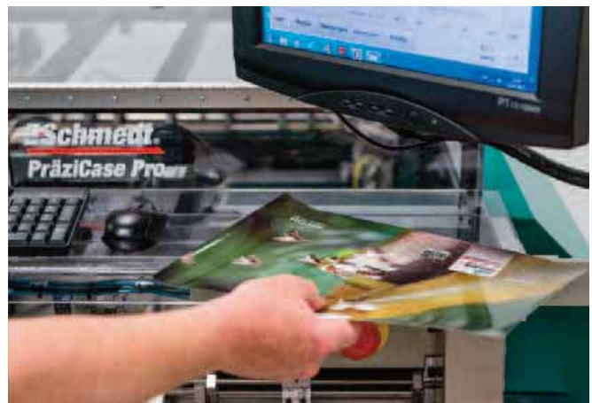
Schmedt PräziCase Pro: Halbautomatische Buchdeckenmaschine für Festeinbanddecken.
