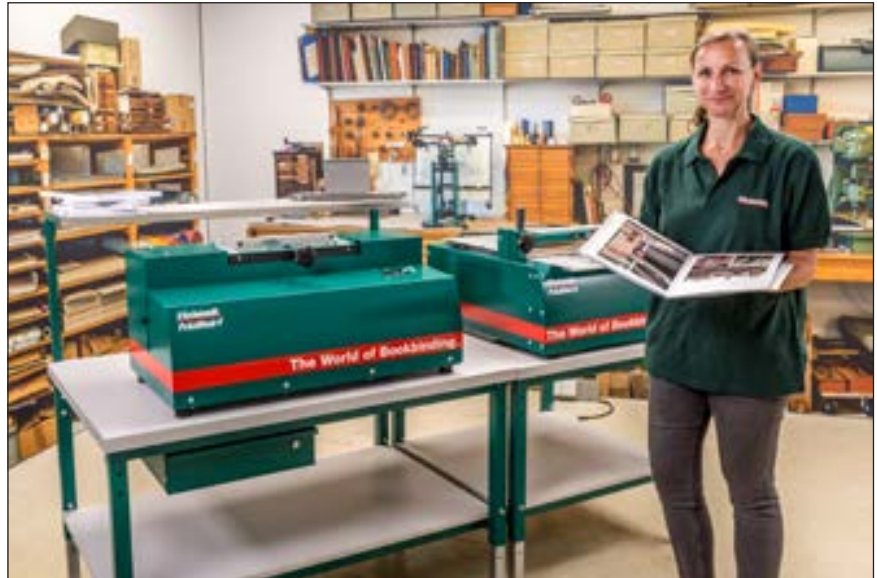
Das Bindesystem PräziBind verarbeitet Block-Formate mit einer Breite von 120 bis 310 mm, einer Höhe von 120 bis 310 mm und einer Stärke von 3 bis 30 mm mit einer Leistung von ca. 50 Blocks pro Stunde.
