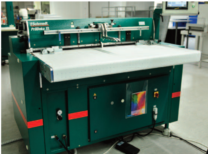
Die neue PräDeka XL bei allcop in Lindenberg ist eine halbautomatische Maschine zur Herstellung von Buchdecken in Sortiment und Serie.
