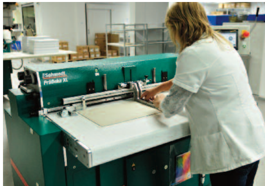
Bei allcop Farbbild-Service wird die PräDeka XL eingesetzt, um Bücher im DIN-A3-Querformat mit Pappstärken von 2 mm und 3 mm herzustellen. Der Einband besteht jeweils aus veredeltem Echtfotopapier.
