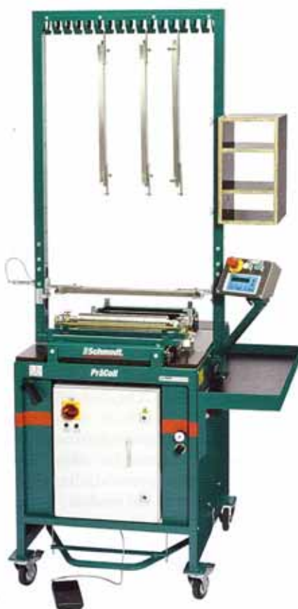
Fächer-Klebebinden mit Prä-Coll Pro: Komfortable automatische Beleimung des Buchblocks. FOTO: SCHMEDT
