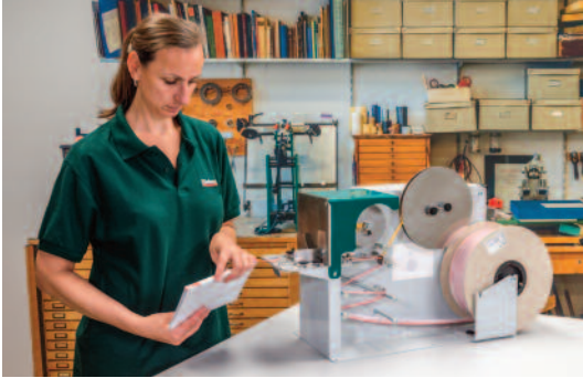
Kapitalband aufbringen mit der PräziBand.
