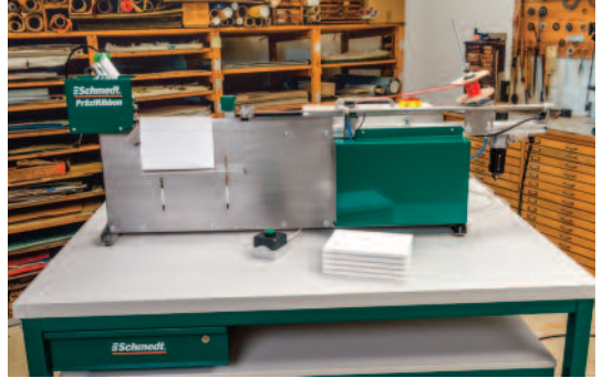
PräziRibbon: Zeichenlitze an den Buchblock ankleben.
