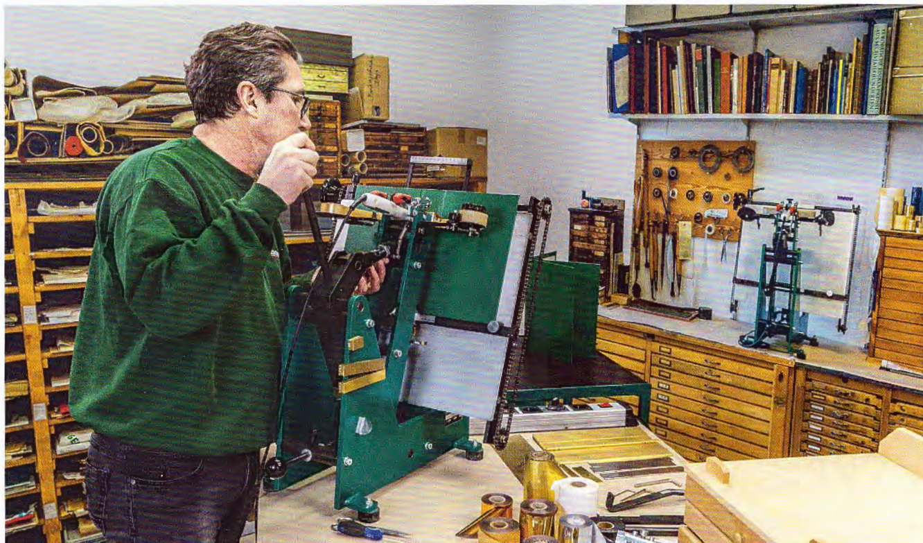
Veredelung mithilfe der PräGnant-Prägepresse.
