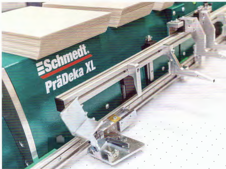
PräDeka XL zur Fertigung von ein- oder mehrteiligen Buchdecken von 15 bis 110 cm Breite.
